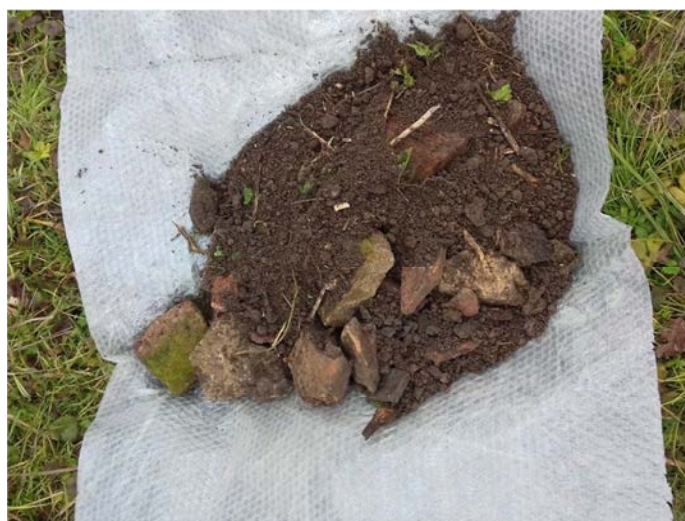
Figura 18. Campionamento per quartatura del materiale in cumulo presente in loc.tà Pioppa – Porto Viro (RO).
